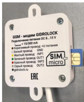
Фото 3 и 4. Установка SIM-карты в GSM-модем GIDROLOCK
