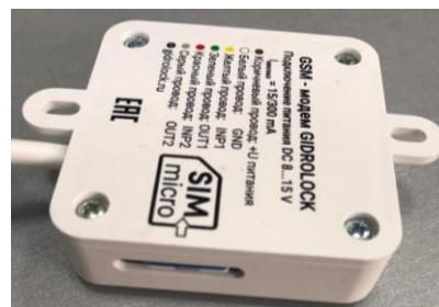
Фото 3 и 4. Установка SIM-карты в GSM-модем GIDROLOCK
