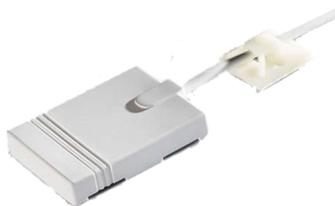
**Датчик протечки воды** предназначен для обнаружения аварийной ситуации при попадании воды на его электроды. Для увеличения срока службы датчика его электроды покрыты золотом.
